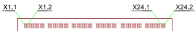
Slika 2. Primjer izgleda 1RU svjetlovodnog ODF-a s 24 x DLC (Duplex LC) s oznakama
