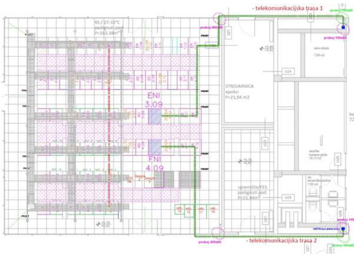
Slika 6 Dispozicijski nacrt kabelaških trasa 2.kat - situacija HR-ZOO ZG1
